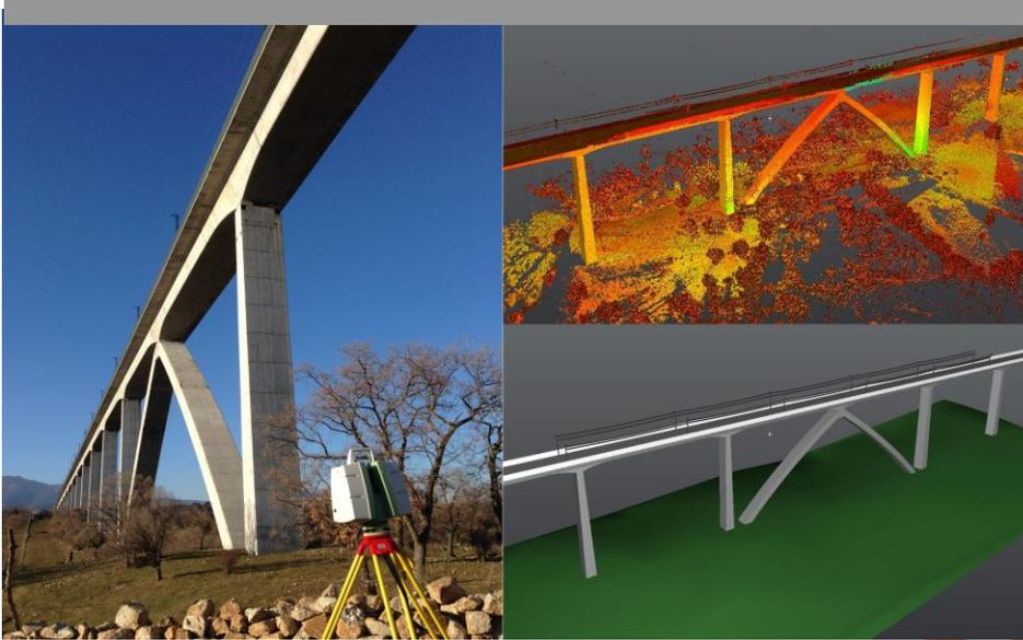
Curso de Tratamiento de Nubes de Puntos, procedentes de diferentes sensores de Leica Geosystems como *Láser Escáner 3D, Drone, Multiestación etc.* Descripción y análisis del flujo de trabajo, desde la toma de datos, tratamiento de los mismos hasta la obtención de producto final, en diferentes entornos y aplicaciones:
