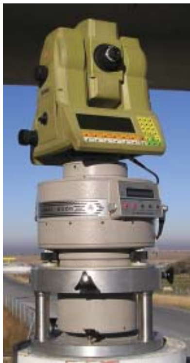
I Estación Total marca LEICA, modelo TCA 2003
