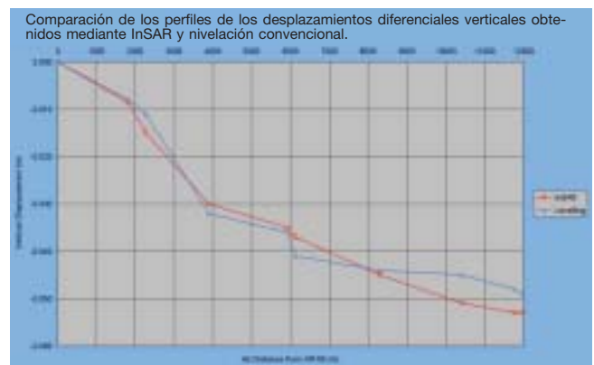
Figura 7: Secciones de los perfiles de las desplazamientos diferenciales verticales obtenidos mediante interferometría InSAR y nivelación convencional.
