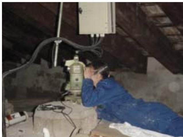
Aunque se debe tomar la precaución de observar de forma sistemática, empleando el mínimo tiempo de observación en cada vértice, en general superior a una hora.
