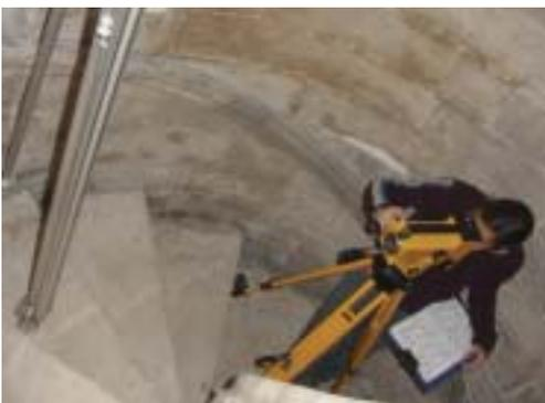
Con el fin de minimizar la acumulación de error en la obtención de las cotas de estos puntos, se dividió la escalera en dos itinerarios:
