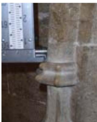
La obtención de desniveles se ha realizado mediante una nivelación geométrica sencilla. Siendo ésta simple y compuesta (mira de espaldas sobre zócalo con cota arrastrada desde M o N) según las condiciones de visibilidad a los tres puntos requeridos: de frente, a la columna correspondiente y de espaldas a M y a N.
