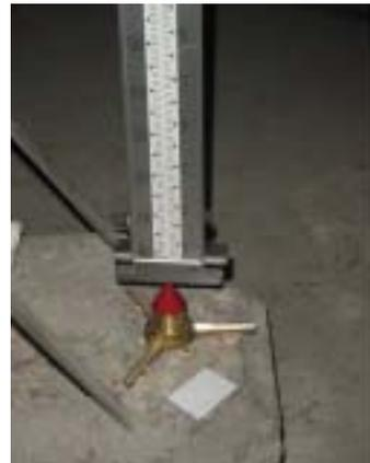
Mientras que para el arrastre de dichas cotas al resto de las claves se ha realizado una nivelación trigonométrica. A pesar de ser este último un método de nivelación menos preciso, se optó por él con el fin de evitar el posible deterioro de las señales de puntería que se pudiera ocasionar al apoyar la mira, así como por ser inviable una nivelación geométrica en la mayor parte de las señales, debido a la escasa altura de la cubierta en determinadas zonas.
