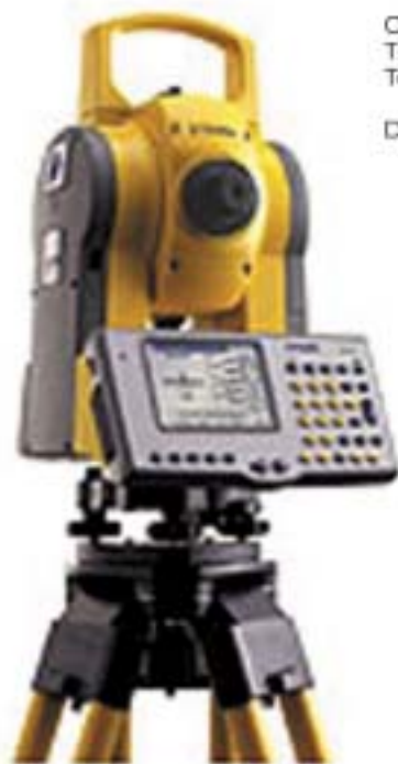
Estación Total Trimble 3600DR con ACU Precisión angular: 10cc Precisión en distancias: 2mm + 2ppm Alcance: 2.500 m Controlador ACU: con software Trimble Survey Controller Medición sin prisma Disponible en 10cc y 15cc
