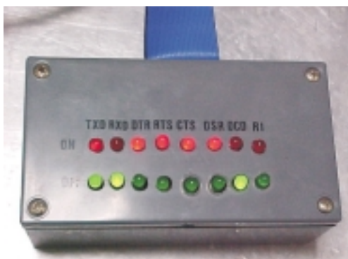
Figura 2. Dispositivo de control de pines (Espía)
