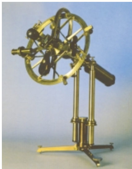
Brújula con alidada de pínulas (M. Naval) y Círculo de reflexión de Borda (IGN).
