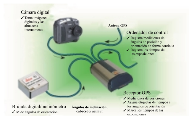
Figura 2. Configuración del sistema de MMS portátil
