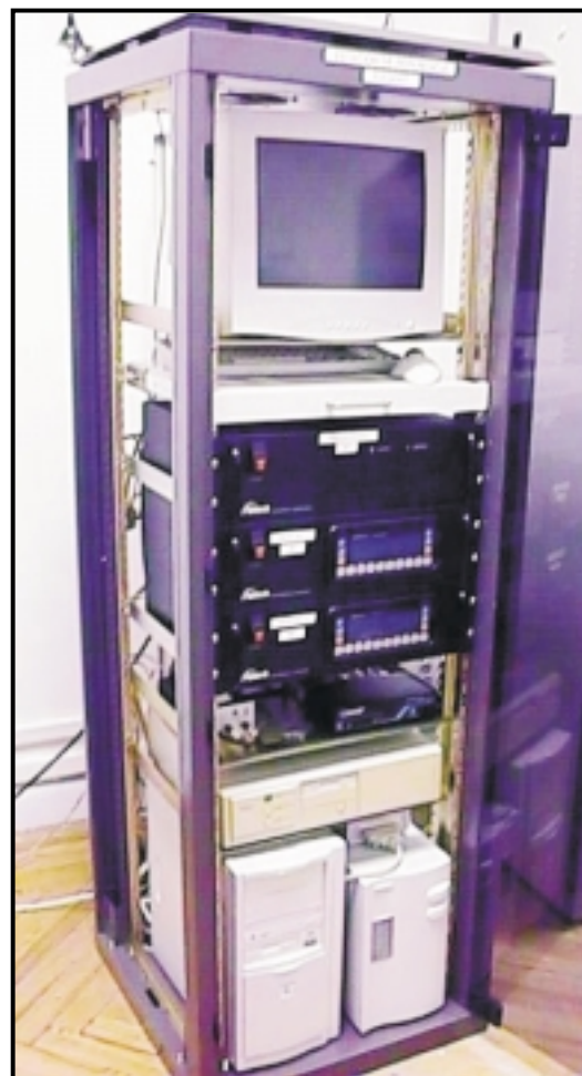
Figura 4. Estación generadora de correcciones diferenciales: 2RS+IM, con UPS, radio FM/RDS/RASANT, ordenador con control y UPS
